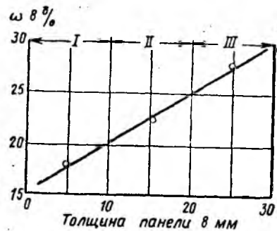
Рис. 118. Кривая влажности по толщине панели при прерывном режиме сушки (расстояние до облучаемой поверхности l=100 мм) I — верхний слой; II — средний слой; III — нижний слой
